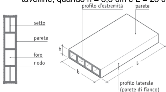
Figura 13.1. Nomenclatura di parti di tavelloni, tavelle e tavelline (fonte: Andil, Tavelloni e tavelle in laterizio: scenari applicativi)
